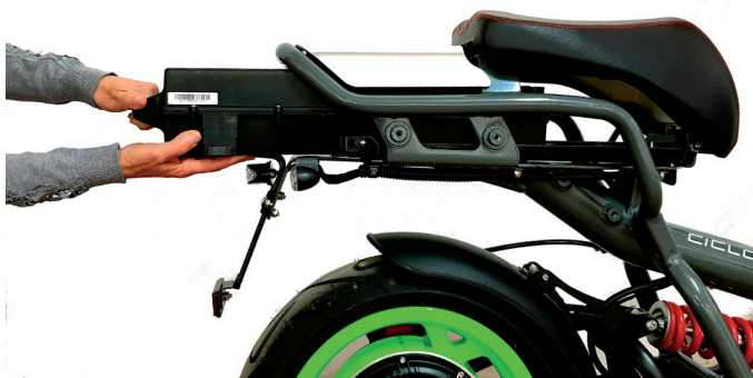
Figure 9 - Extraction de la batterie
