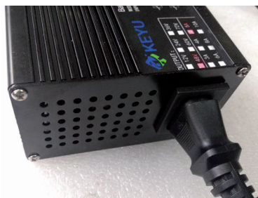
Figure 10 - Connexion du chargeur secteur
